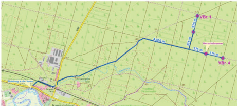
Abbildung 3: Leitungsführung zum Abschlagen des im Rahmen des Grundwasserleitertestes geförderten Grundwassers in die Spree
