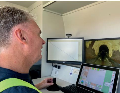
6) Stefan Jäger steuert die Kamera vom Inspektionsfahrzeug aus. Auf dem mittleren Monitor kann er die Fahrt verfolgen. Durch Gase aus dem Abwasser wurde die braune Glasur der Rohre angegriffen, die Stellen leuchten weiß. Haarrisse oder Löcher sind nicht zu erkennen, auch die Neigung des Kanals ist in Ordnung. Ein Ingenieur wird das Video noch einmal prüfen und bei Bedarf Reparaturen veranlassen.
